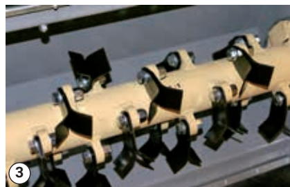
Проверка на остриета на ножове
