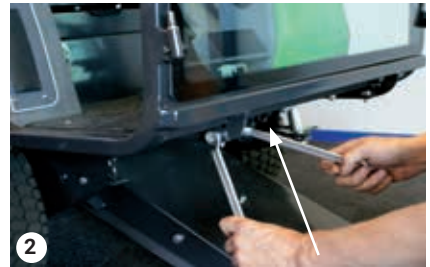
Bolzen unter der Bodenplatte
