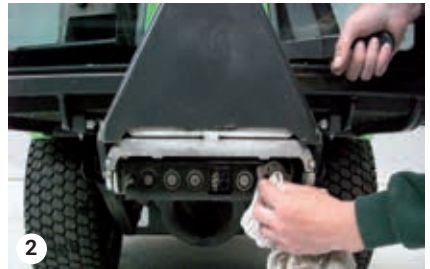
2 Reinigung der Schnellkupplungen – Frontkuppeldreieck
