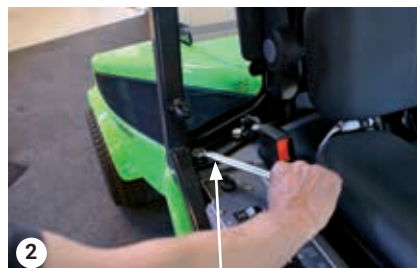
2 Bolzen einsetzen, jeweils zwei auf jeder Seite
