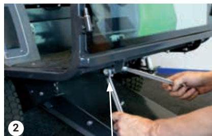
Bolzen unter der Bodenplatte
