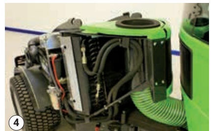
4 Kühler mit Luftdruck reinigen.
