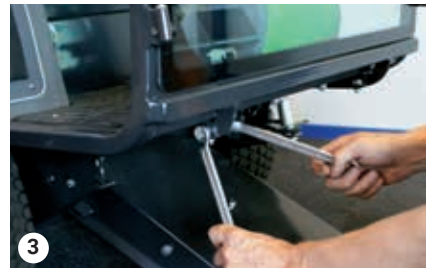
Bolzen unter der Bodenplatte
