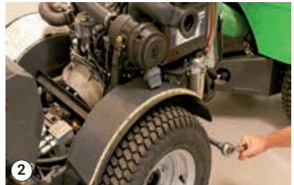
Rechtes Hinterrad ausbauen
