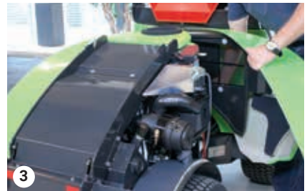
Abbau der Seitenverkleidung
