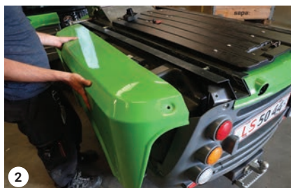
Zugang zu: Batteriefach
