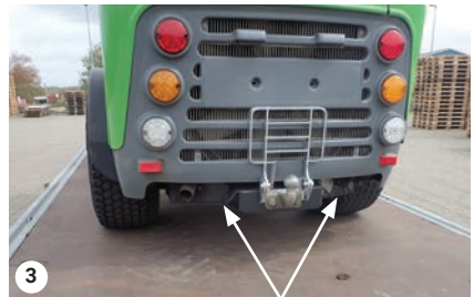
Verankerung hinten, zwei Verankerungsbügel
