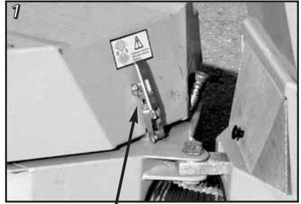
Das Haubenschloss muss verriegelt sein
