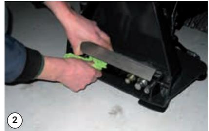
Die Kupplungen mit einem Tuch reinigen
