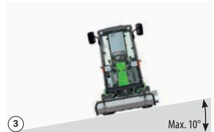
Gelände mit mehr als  $10^\circ$  Neigungswinkel darf nicht befahren werden.
