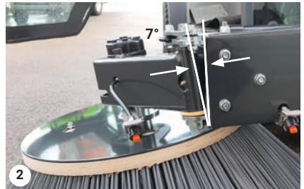
2 Frontkehrmaschine gekippt – bis zu 7°
