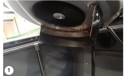
Überprüfen des Drehfilters und der Turbine
