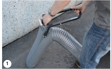
Den externen Schlauch zur Reinigung des Systems verwenden.
