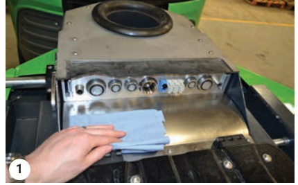
Die Schnellkupplungen mit einem Tuch reinigen
