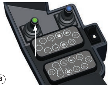
Linker Joystick der linken Bürste Rechter Joystick der rechten Bürste
