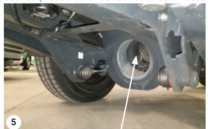
Das Leitungsauslasssystem am A-Rahmen der Maschine reinigen.
