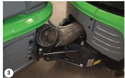
Den Schlauch an der Gelenkverbindung reinigen
