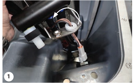
1 Zur Seite drehen und herausziehen. Anschlussloch
