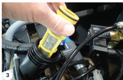
3 Filter reinigen oder austauschen
