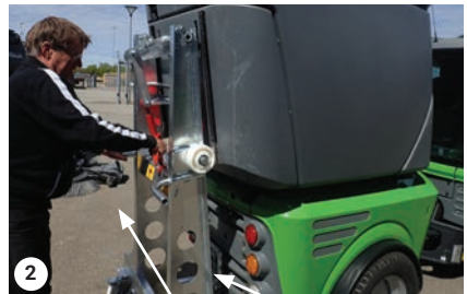
Den Kehrgutbehälter mit dem Sperrhaken-Ladeträger auf den Rahmen absenken
