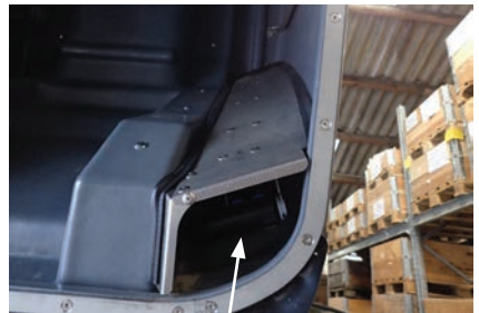
Die Klappe an allen Filtern entfernen.
