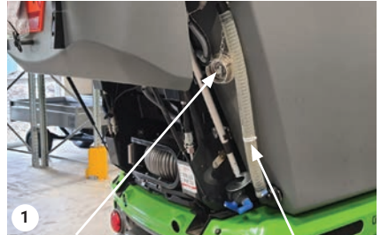
1 Die Filterkupplung öffnen und min. bis zum Wasseretikett Wasser einfüllen (ca. 125 l)
