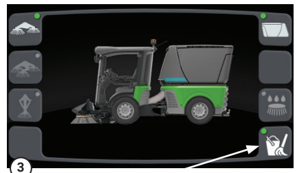
Den „Behälter“ 3 Sek. gedrückt halten, bis das grüne Licht eingeschaltet wird.
