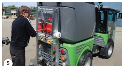
Den Anbaurahmen andrücken und sicherstellen, dass die Haken an den Hebevorrichtungen richtig angebracht sind.
