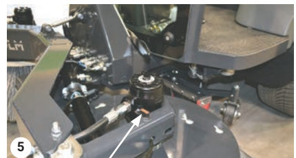
Ventil an der vorderen Bürste für 3. und 4. Düse angebracht
