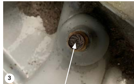
Den Stahlfilter an der Saugdruckvorrichtung reinigen
