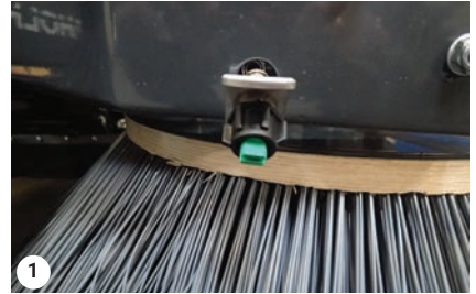
Die Mutter an der Düse aufschrauben
