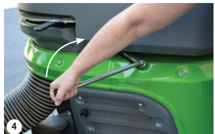
Der Sperrhebel wird gedreht
