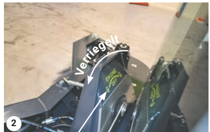
Den Sperrhebel in die Sperrposition drehen.
