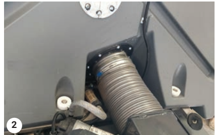
Den externen Schlauch durch Lösen der Schlauchklemmen abschließen.
