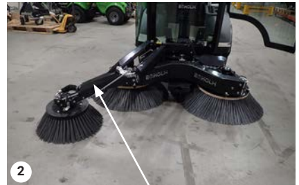
2 Abdeckung entfernen (Bürste in ausgefahrener Position)
