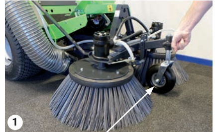
Stützrad für Bürsteneinstellung
