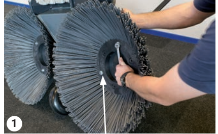
Austausch der Bürsten: Bolzen lösen
