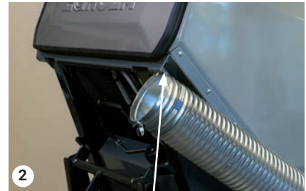
Halter für den Saugschlauch
