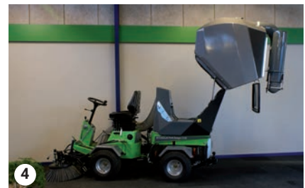
Entleerung des Kehrgutbehälters
