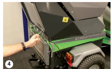
Vor Inbetriebnahme - Den Stahldraht ziehen
