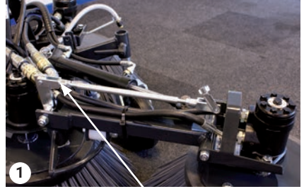
Beschlag zur Winkeleinstellung des Seitenbesens
