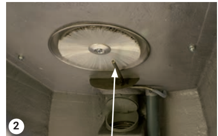
Wasserdüse im Kehrgutbehälter
