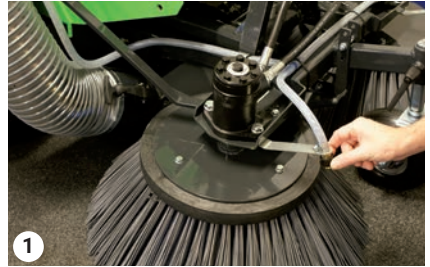
Düsen reinigen / Filter austauschen
