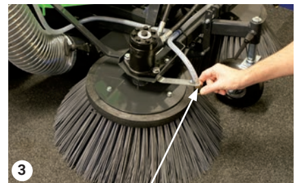
Wasserdüsen vorne an den Frontbesen
