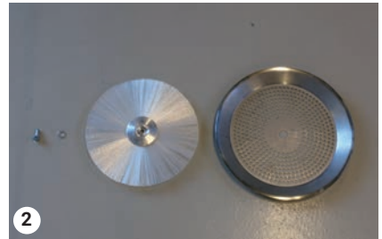
2 Bolzen, Lochscheibe, Rotorfilter, Lochscheibe
