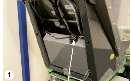
Einfüllen von Wasser
