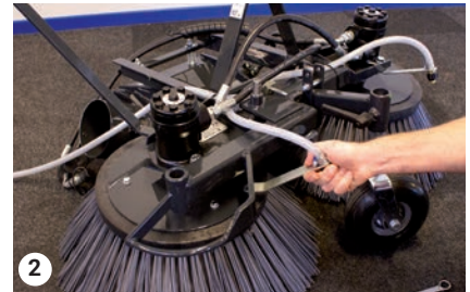
Bolzen wieder verschrauben
