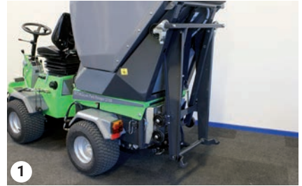
Transport der Abstellstütze am Kehrgutbehälter
