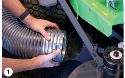
Saugschlauch an den Saugmund hängen
