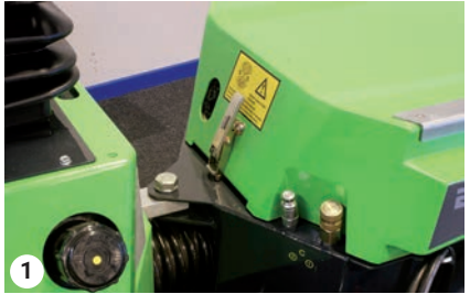
1 Das Motorhaubenverschluss muss verriegelt sein!
