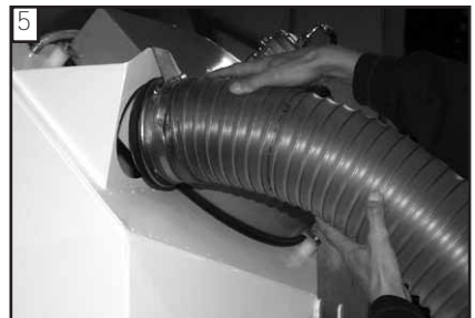
Der Saugschlauch wird auf den Stützen des Kehrgutbehälters aufgesteckt.
