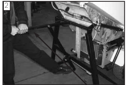
Absenkung des Kehrgutbehälters Hebel
