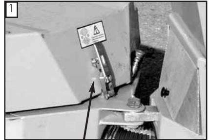
Das Motorhaubenverschluss muss verriegelt sein!
