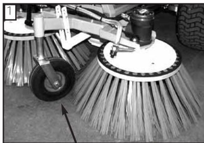
Stützrad für Bürsteneinstellung
