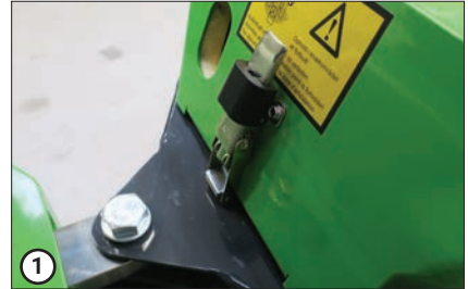
Die Motorhaubenverriegelung muss befestigt sein
