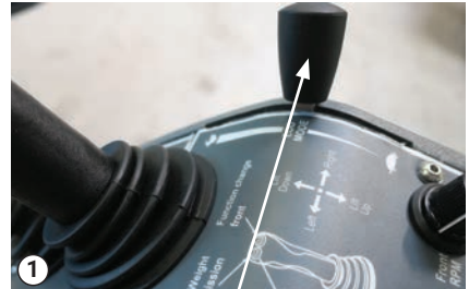
Den Gashebel nach vorn drücken, bis er halb geöffnet ist.
