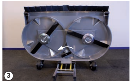
Laufrichtung der Messer
