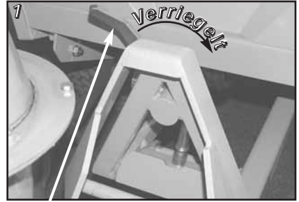
Verriegelung am Frontkuppeldreieck (unverriegelt)
