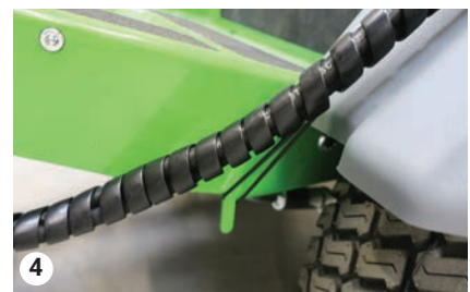
Hydraulikschläuche mit dem Gummiring befestigen
