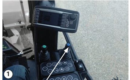
Schwenken Sie die Bürste nach links und rechts.
