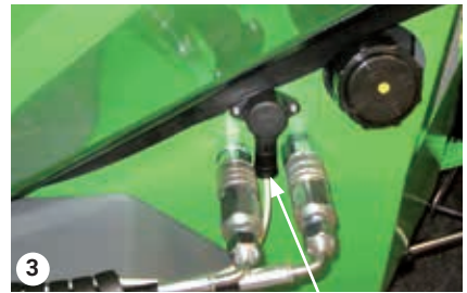
Hydraulikschläuche und Stromstecker montieren
