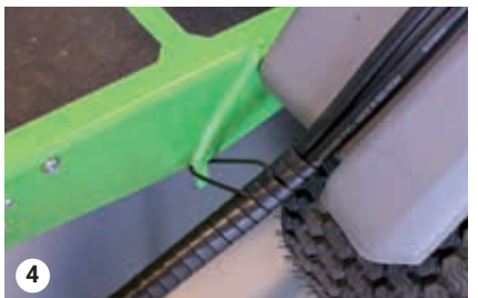
Schläuche werden mit einer Gummischlaufe befestigt
