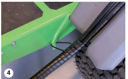
Schläuche werden mit einer Gummischlaufe befestigt
