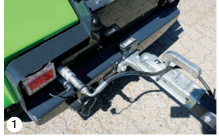
Die Anhängerkupplung, den Hydraulikschlauch (und den Stromstecker, falls vorhanden) anschließen.
