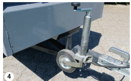
Sicherstellen, dass sich das Bugrad in der oberen Position befindet.
