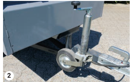
Sicherstellen, dass sich das Bugrad in der oberen Position befindet
