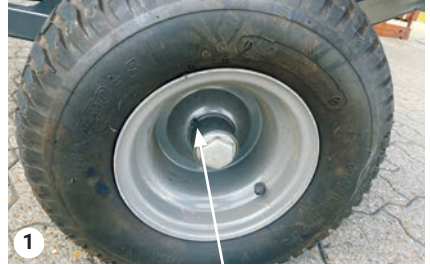
Schmierstellen in den Rädern einfetten.
