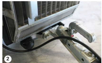
Die Anhängerkupplung, den Hydraulikschlauch (und den Stromstecker, falls vorhanden) anschließen.
