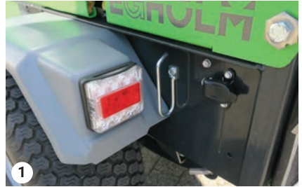
Die Schlauchhalterung, die mit dem Kippanhänger geliefert wird, montieren.
