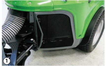
Öffnen der Seitenverkleidung
