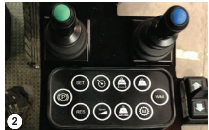
2 Linker Joystick - Linker Flügel Rechter Joystick - Rechter Flügel
