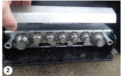
Reinigen Sie die Schnellkupplungen
