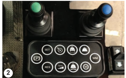
Linker Joystick - Absenken des Mähers Rechter Joystick - Kippen des Mähers
