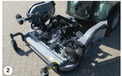
Klingen in angehobenen Flügeln stoppen automatisch
