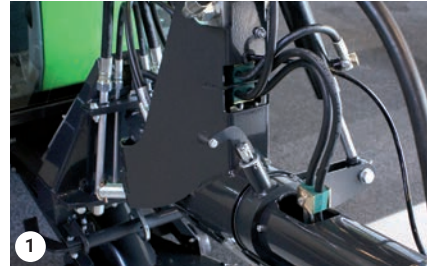
Sperrklinke in entriegelter Position
