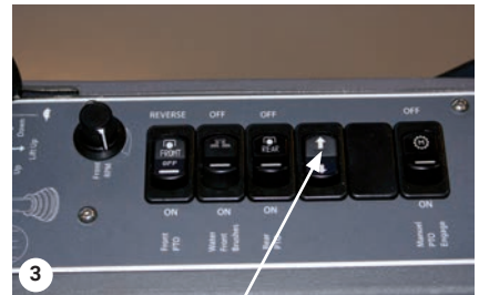
Schalter F2, verriegelte Position
