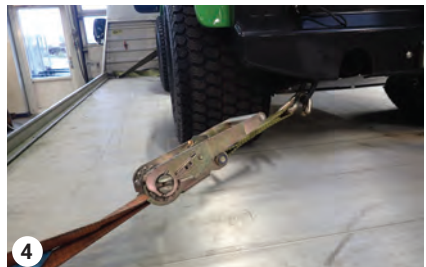
Stropper ved bagenden
