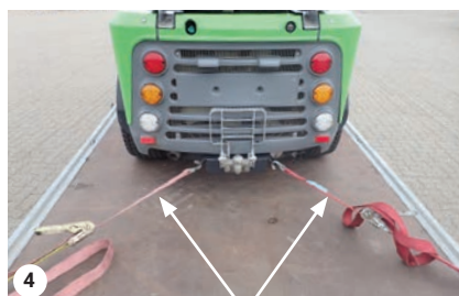
Stropper ved bagenden
