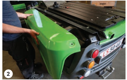
Adgang til: Batterikammer
