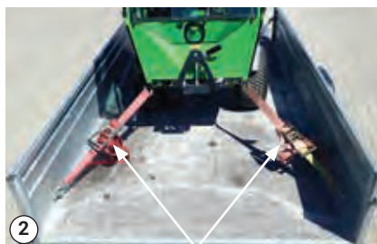
Stropper ved forenden
