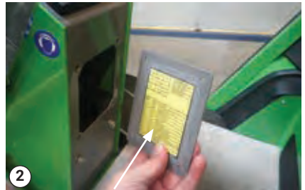
Oversigt over sikringer - Bagsiden af sikringsdækslet
