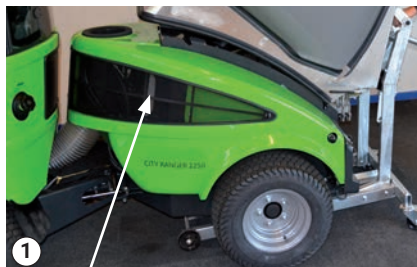
Tænd og sluk funktion bag venstre bagskærm
