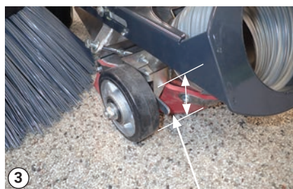
Justering af gummiets afstand til jorden
