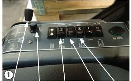
Gashåndtag | PTO for F1 (vand) | PTO bag RPM for (hastighedsregulering af forkoste)
