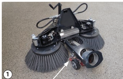
1 Предна четка 22FBAA – вакуумна дюза
