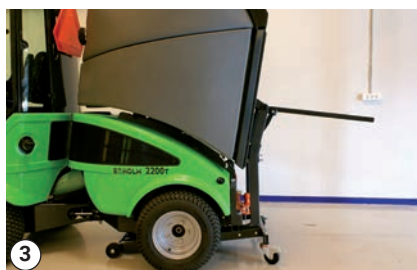
Монтиране на бункера
