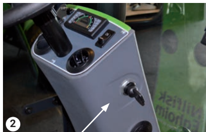
2 Контактен ключ (включвател на запалването) – позиция 1
