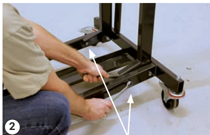
Двата болта на рамата на бункера
