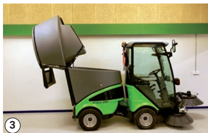
Напълно наклонен бункер
