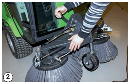
Наклонете прикачното приспособление към машината.
