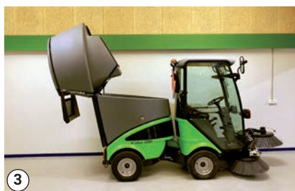
Бункерът се наклонява изцяло назад
