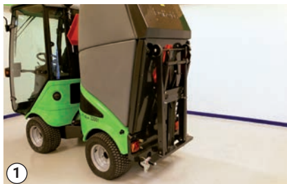
Транспортиране на рамата на бункера на бункера.
