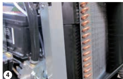
4 Vyčistíte chladič pomocí stlačeného vzduchu
