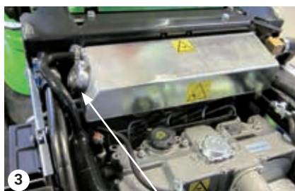
Vyrovnávací nádrž – zkontrolujte hladinu chladicí kapaliny
